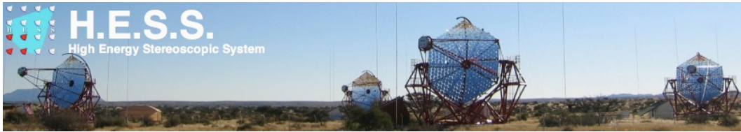
FIGURE 84 – Télescope Cerenkov HESS en Namibie. L’analyse du signal en provenance des télescopes du réseau permet de remonter à la direction et à l’énergie du photon incident.
